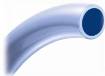
Кольца в FEP/PFA-оболочке - это эластомерная сердцевина в бесшовной наружной оболочке. Эластичная резиновая сердцевина, изготавливаемая из фторкаучука FKM (Viton®) или силикона VQM, создает равномерное усилие в контактной зоне, а оболочка из фторированного этилен-пропилена FEP или перфторалкокси PFA гарантирует высокую стойкость к агрессивным корродирующим средам.
